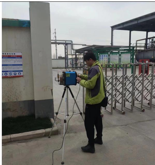
无组织废气监测照片
